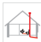
Ventilation des canalisations
